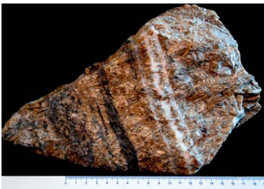
Abb. 9: Gebänderter, grobkristalliner Siderit mit Quarz eines Siderit-Quarz-Ganges. Grube „Pfannenberger Einigkeit“ bei Salchendorf, 700-m-Sohle (Foto: Frank HÖHLE).
