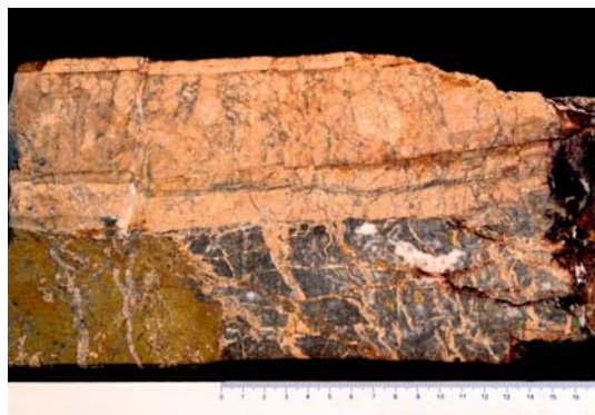
Abb. 12: Siderit eines Siderit-Quarz-Ganges mit jüngerem Kupferkies der Zinkblende-Bleiglanz-Gänge. Deutlich sichtbar die Fältelung des Siderits im Nebengestein (gesägtes Gangstück). Grube „Victoria“ bei Littfeld (Foto: Frank HÖHLE).
