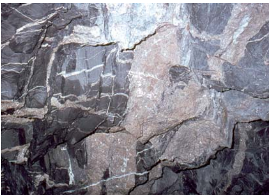
Abb. 3: Grobspätiger („spangeliger“) Sideritgang mit Quarztrümmchen (weiß) eines Siderit-Quarz-Ganges in gebänderten Tonschiefern des Siegens (Unterdevon) in der Stollenfirste. Es handelt sich hier nicht um den Hauptgang der Grube, sondern um ein Nebentrum. Deutlich zu erkennen die intensive tektonische Beanspruchung des Siderits mit Einschnürungen. Grube „Füsseberg“ bei Biersdorf, 18. Sohle, Einigkeiter Mittel, Abbau zwischen Querschlag 6 und 8 (Foto: Hans-Joachim LIPPERT, 23.2.1965).
