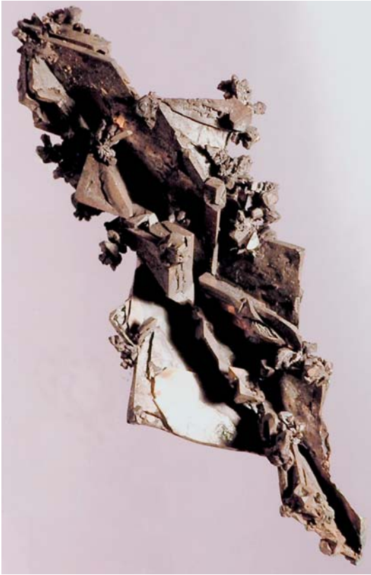
Abb. 39: Cuprit in Brauneisenstein der Oxidations- und Zementationsbildungen. Grube „Käusersteimel“ bei Kausen, Bb. 15 cm (Foto: Matthias REINHARDT).
