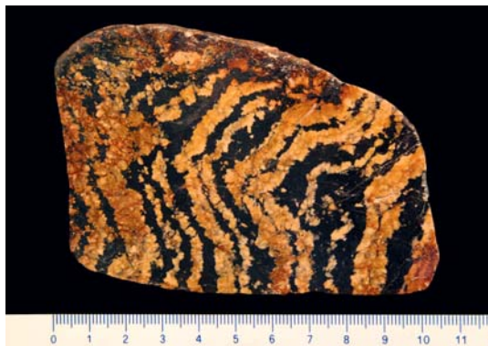
Abb. 13: Gefalteter Siderit eines Siderit-Quarz-Ganges in Wechsellagerung mit jüngerem Sphalerit der Zinkblende-Bleiglanz-Gänge (poliertes Gangstück). Grube „Füsseberg“ bei Daaden (Foto: Frank HÖHLE).
