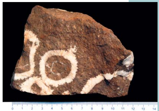
Abb. 10: Konzentrische Verwachsung von Siderit (dunkelbraun, da als Haldenfund oxidiert) und Quarz („Ringelerz“) eines Siderit-Quarz-Ganges, gedeutet als hydrothermale Breccie. Grube „Anxbach“ bei Lorscheid (Foto: Frank HÖHLE).
