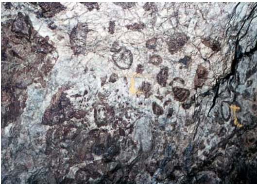
Abb. 7: Hydrothermale Breccien („Kokardenerz“) aus Siderit (dunkel) und Quarz (weiß) in einem Siderit-Quarz-Gang, schwach deformiert. Höhe der gelben Kreidemarkierung: 10 cm. Grube „Füsseberg“ bei Biersdorf, 19. Sohle, Auffahren im Füsseberger Mittel (Foto: Hans-Joachim LIPPERT, 23.2.1965).
