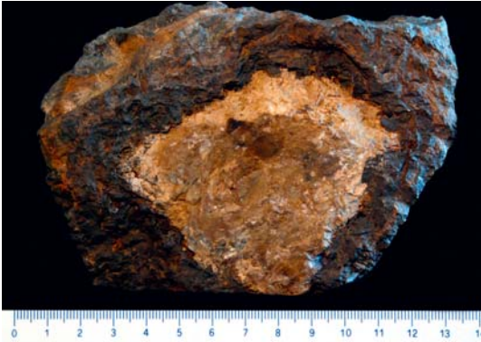
Abb. 29: Siderit der Siderit-Quarz-Gänge, randlich in Brauneisenstein der Oxidations- und Zementationsbildungen übergehend. Grube „Eisenzecher Zug“ bei Weidenau (Foto: Frank HÖHLE).
